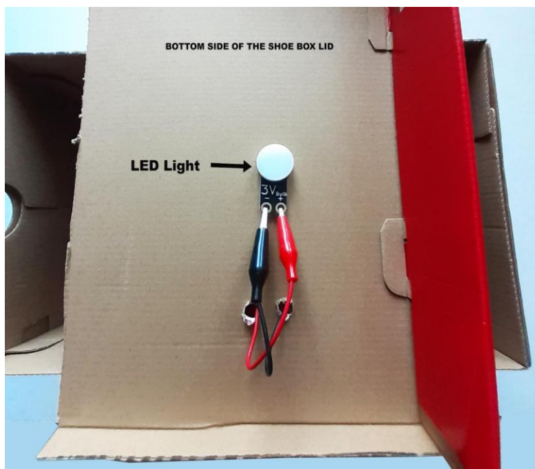
Rysunek 12: Podłączenie klipsów aligatorowych do lampy LED, która umieszczona jest na dole pokrywy Rysunek 13 pokazuje przekrój przez papierowy model ze wszystkimi komponentami w docelowych pozycjach, natomiast Rysunek 14 pokazuje wnętrze papierowego modelu z włączoną diodą LED.
