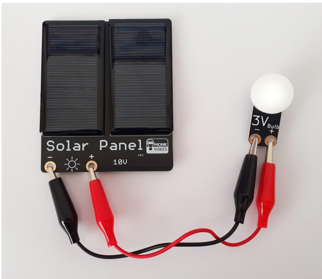
Rysunek 1: Podłączenie lampy LED do panelu słonecznego za pomocą dwóch przewodów krokodylkowych. Połącz zaciski + i – panelu słonecznego z zaciskami + i – lampy LED.
